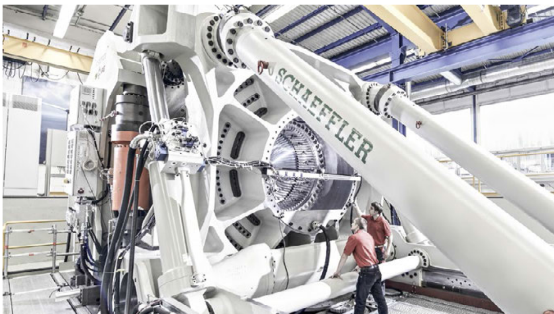
Meterware: Großlager- prüfstand Astraio in Schweinfurt
