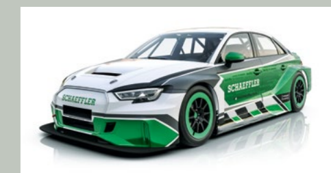
Schaeffler 4ePerformance: Das rein elektrisch angetriebene Fahrzeug verfügt über vier Formel-E-Motoren mit einer Gesamtleistung von 880 kW (1.200 PS)
