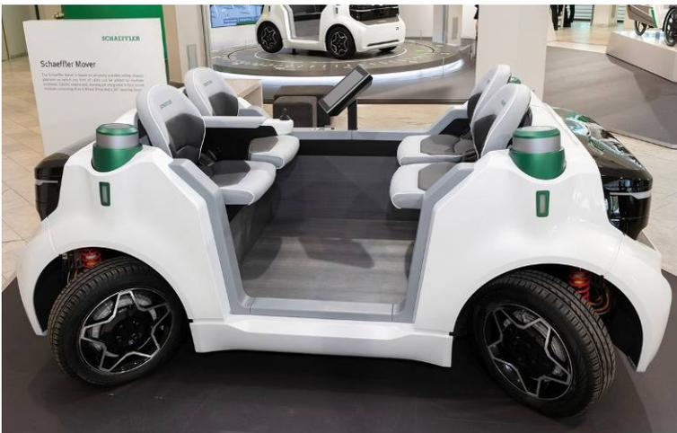
BU: „Schaeffler Mover“: Das kleine und sehr wendige Fahrzeugkonzept ist rein elektrisch betrieben und kann – mit verschiedenen Aufbauten versehen – in urbanen Räumen für flexible Transportaufgaben eingesetzt werden.
