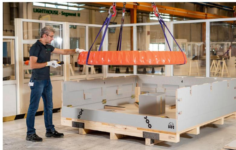
Die Schaeffler SMART-Box – ein nachhaltiges Mehrwegsystem für die Großlagerlogistik. Sie ist für Lager mit einem Außendurchmesser von 350 bis 2.400 mm im Einsatz.
