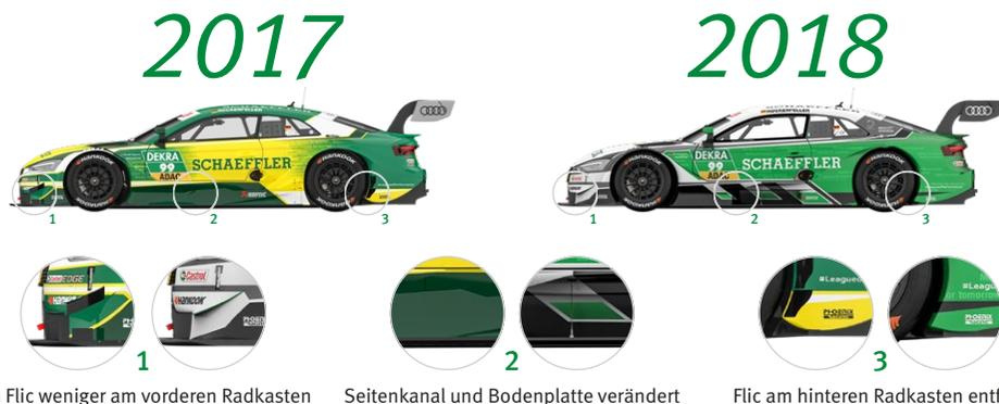
Ein Flic weniger am vorderen Radkasten    Seitenkanal und Bodenplatte verändert    Flic am hinteren Radkasten entfällt
