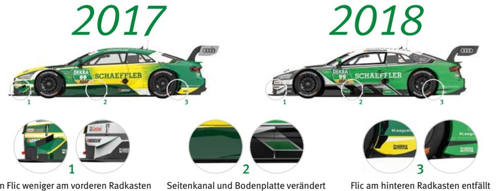
→ 25 Prozent geringerer Abtrieb und damit mehr Spektakel für die Fans
