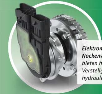
Elektromechanische Nockenwellenversteller bieten höhere Stellgeschwindigkeiten als hydraulische Systeme
