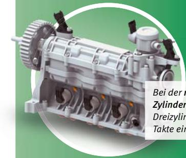
Bei der rollierenden Zylinderabschaltung eines Dreizylinders setzt alle vier Takte ein anderer Zylinder aus
