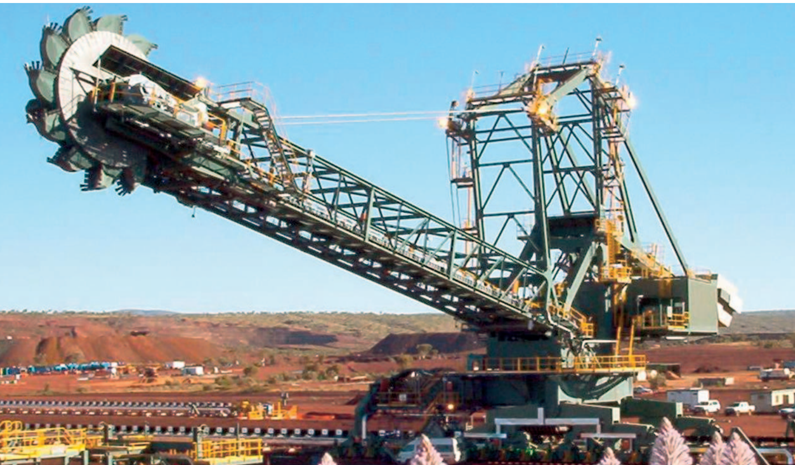
VOEST-Alpine Schaufelrad-Rückladebagger VARL 1800.
