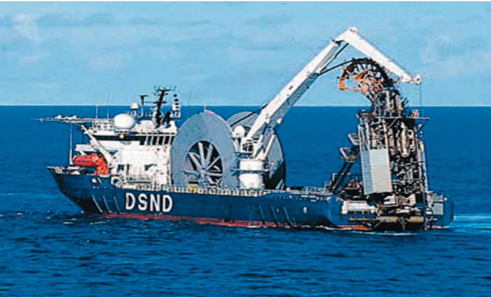
Rohrverlegeschiff „Skandi Navica“ der Firma DSND
