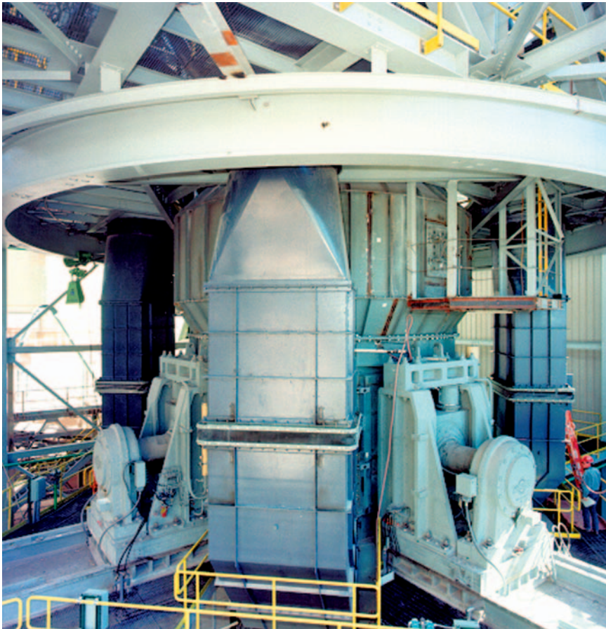
QUADROPOL Rollenmühle mit Spezial-Pendelrollenlagern Werkfoto: Polysius AG
