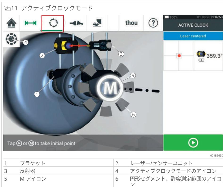
円形セグメントの色が変わると、次のセグメントが点滅するまでシャフトが回転し続けます。M アイコンを再度タップすると、次の測定を行います。合計 8 つの許容測定範囲を使用できます。3 つまたは 4 つのポイントを測定すると、結果画面が表示されます。緑のサムアップアイコンが表示された場合、機械は正しく調整されており、さらなる調整は不要です。赤のサムダウンアイコンが表示された場合は、機械に配列の狂いがあります。
