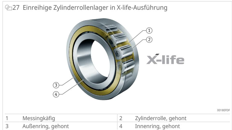
Gerade da, wo aufgrund höherer Pumpenlasten Kugellager nicht ausreichen, kommen die Vorteile von Zylinderrollenlagern mit Käfig zum Tragen. Diese verfügen über deutlich höhere Tragzahlen zur Aufnahme von radialen Lasten und stellen ideale Loslager dar. Durch die bauformbedingte radiale Steifigkeit lassen sich geringe Spaltmaße der Pumpengeometrie sicher einhalten.
