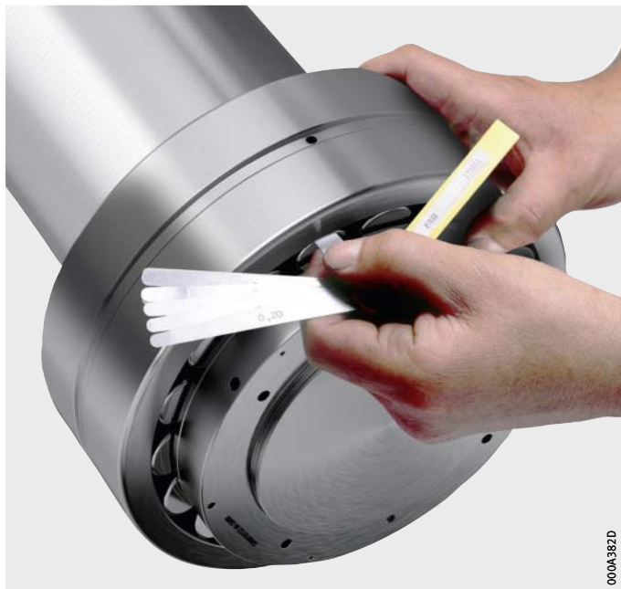
Figura 12 Medición del juego radial reducido
