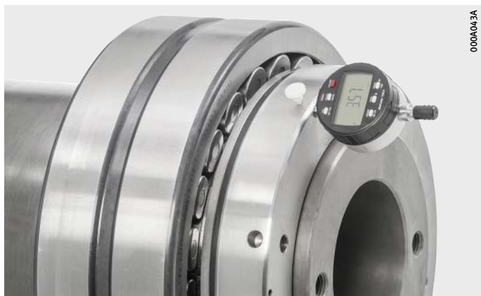
Figura 10 Medición del desplazamiento axial
