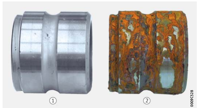
図 2 塩水噴霧試験後の部品 (コーティングあり／なし)
