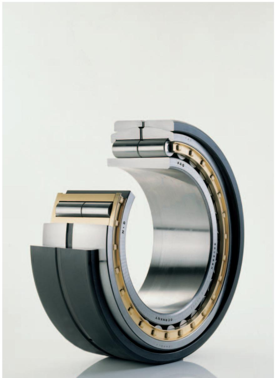
3: Winkeleinstellbare Zylinderrollenlager sind ideale Loslager für Trockenzyllinder, Glätzzylinder und Leitwalzen. Schmiernuten und Schmierbohrungen im Außenring und im Gelenklagerumring ermöglichen die direkte Schmierstoffzuführung zu den Wälzkontakten.
