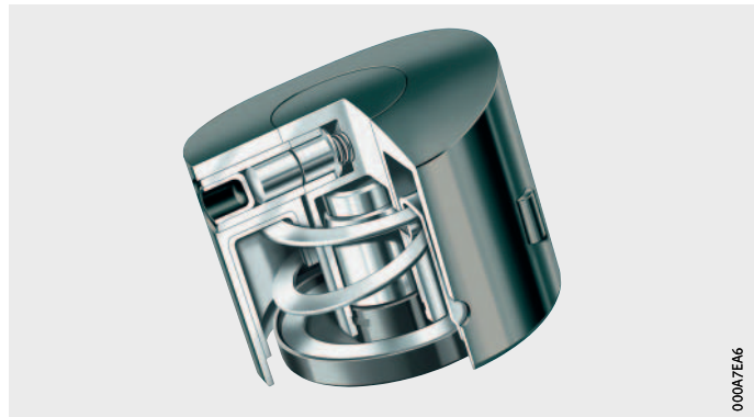
Bild 7 Schaltbarer hydraulischer Tassenstößel
