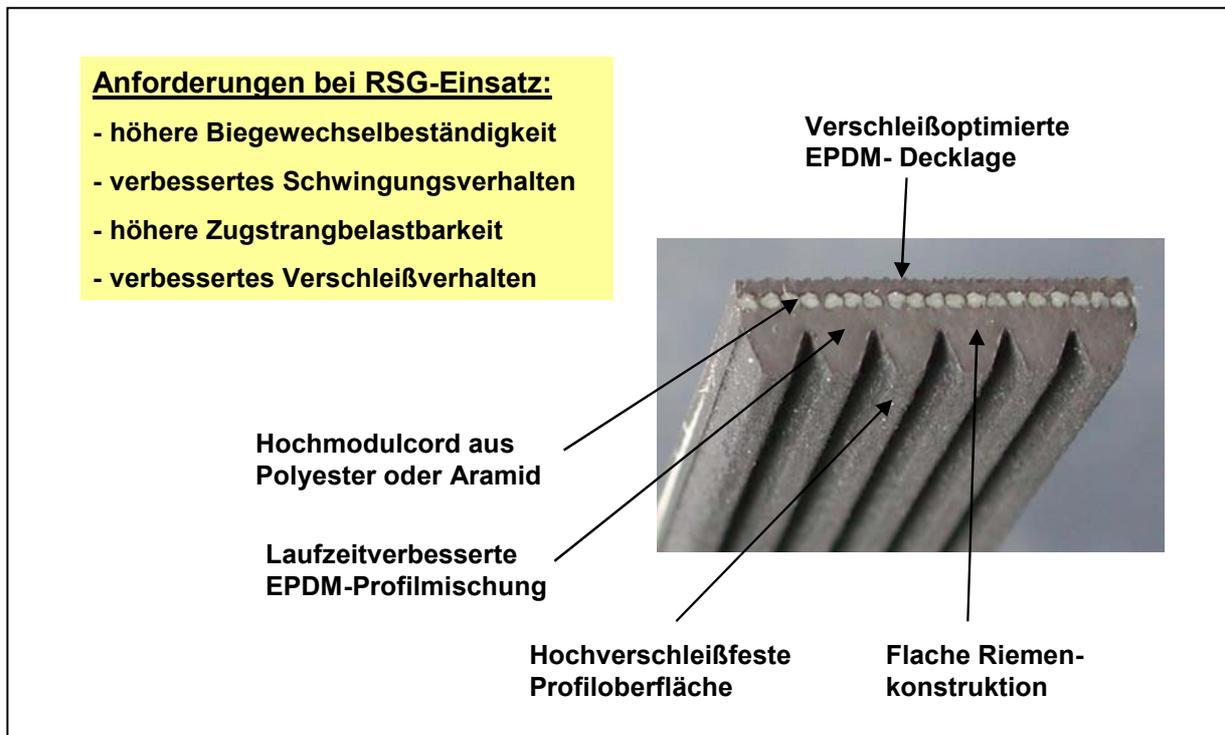
Bild 4: Keilrippenriemen für RSG-Applikationen: UNIPOWER<sup>®</sup> BSA
