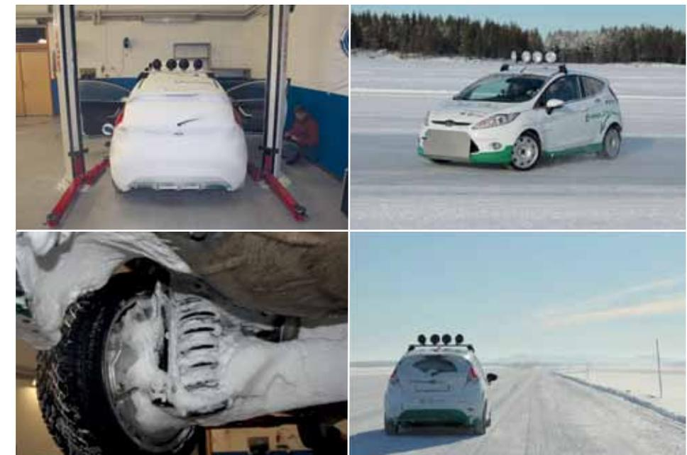
Bild 10 Radnabenantrieb während der Wintererprobung
