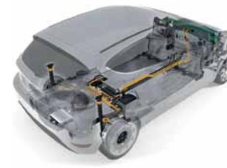
**Bild 7** Einbausituation des Radnabenantriebs in einem Erprobungsfahrzeug
