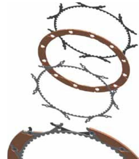
Bild 11 Ausführung einer Verbund-Reibscheibe
