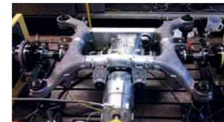
**Bild 4** Prototyp eines elektrischen Hinterachs-antriebs für ein heckgetriebenes Fahrzeug
