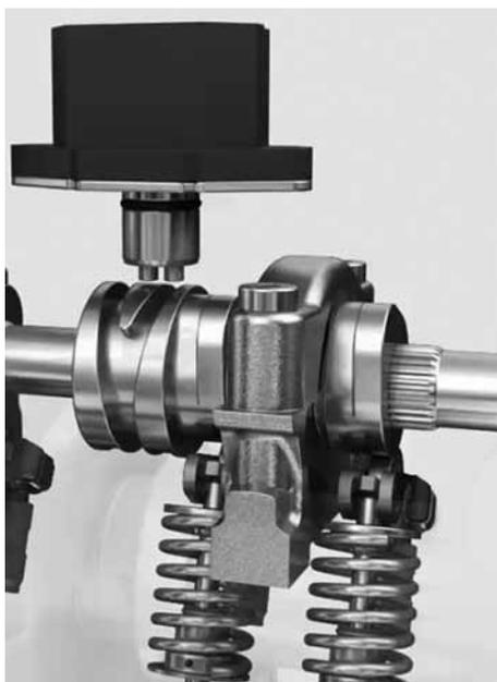
**Bild 14** Zweistufiges Schiebenockensystem
