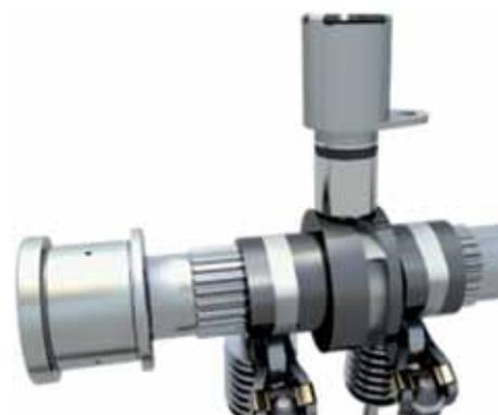
**Bild 15** Dreistufiges Schiebenockensystem
