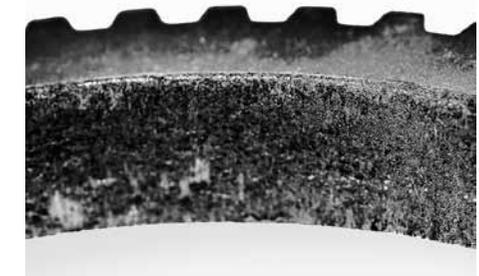
**Bild 5** STC 300: Reibbelag aus Verbundmaterial auf Carbonbasis
