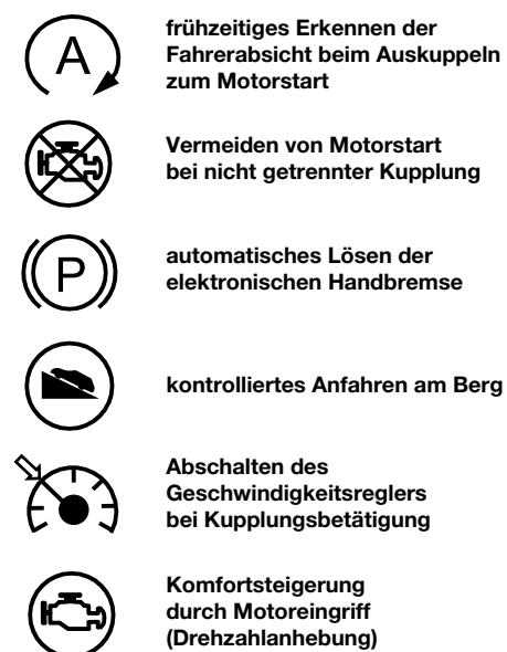
Bild 8 Nutzung des Sensorsignals aus dem Kupplungsgeberzylinder im Fahrzeug
