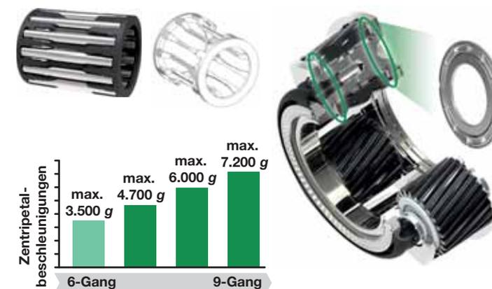
**Bild 2** Zentripetalbeschleunigungswerte in der Planetenlagerung von Automatgetrieben und neuartige Axialnadellagerung für Planeten mit hoher Relativedrehzahl
