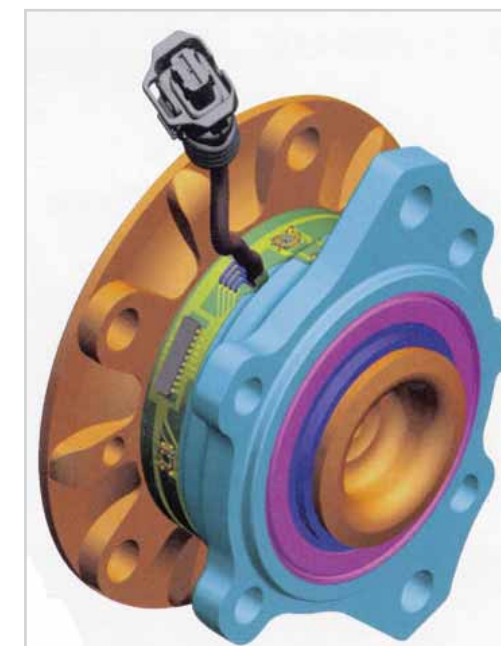
Bild 7 Das intelligente Schaeffler Rad-Modul
