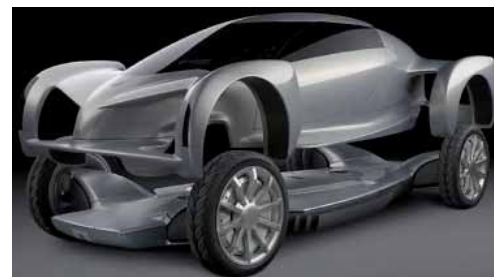
Bild 10 Skateboard mit Chassis und Body [2]
