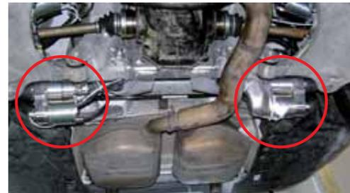
**Bild 6** Radselektive Aktuatoren für AHK in Schaeffler Demonstrationsfahrzeug
