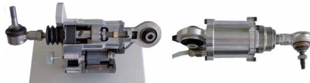
Bild 3 Bauformen der AHK mit achsparallelem (links) und koaxialen (rechts) E-Motor für eine radselektive Betätigung der Vorspur. Länge x Durchmesser für koaxialen Aktuator 130 mm x 85 mm ohne ECU
