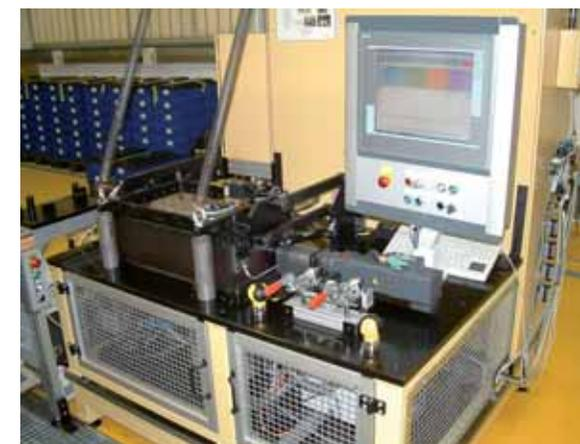
Bild 14 End of Line Prüfstand / Prüfkriterien
