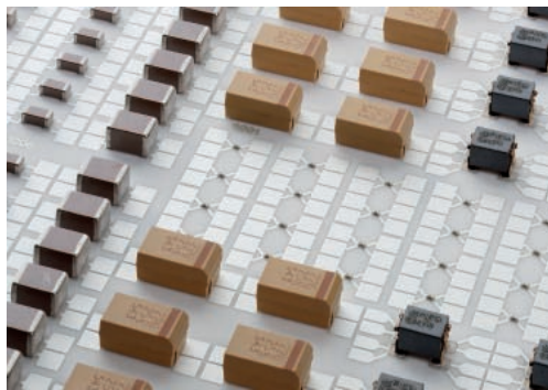
图8 检测用于变速箱控制的新型组件封装导电胶互连基片（局部放大图）
