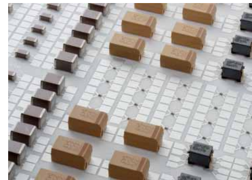
Bild 8 Testsubstrat zu Leitklebverbindungen neuer Bauteilformen für den Einsatz in Getriebesteuerungen (Ausschnitt)
