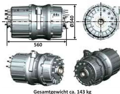
Bild 7 Maße und Gewicht des Prototypen
