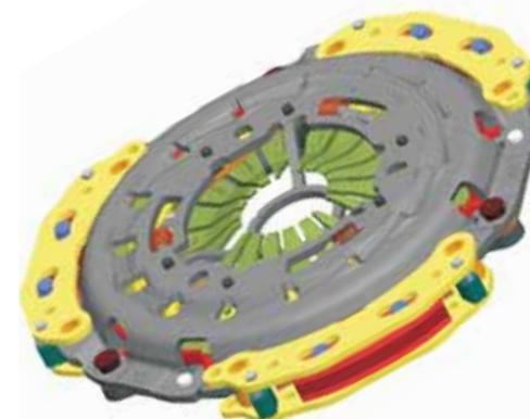
Bild 17 Fliehkraftpendel in der Kupplung
