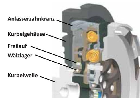
Bild 18 Konventionelle Freilaufanordnung für ein Stopp-Start System mit PES
