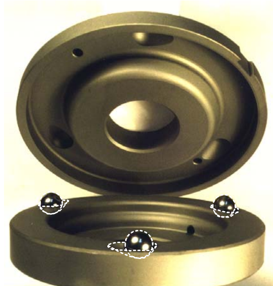
Bild 9: Rampen in Umfangsrichtung angeordnet
