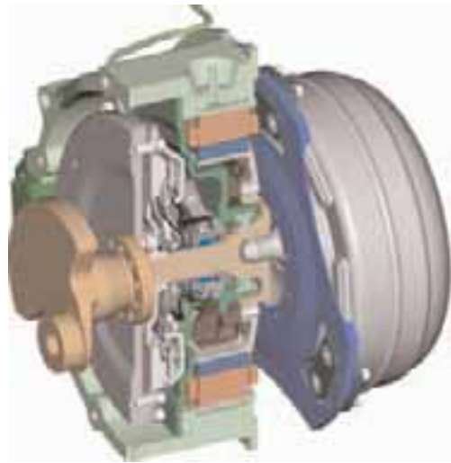
Bild 12 Trockenkupplung zwischen Kurbelwelle und E-Maschine beim Automatikgetriebe mit Wandler, schwere Seite der Kupplung auf der Kurbelwelle
