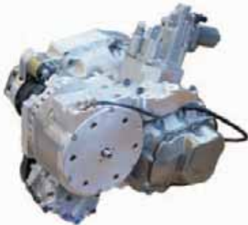
Bild 28 Prototypgetriebe mit seitlich angeflanschter E-Maschine
