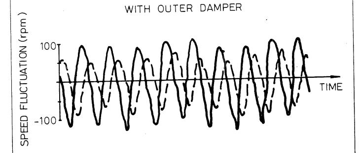
ENGINE SPEED 400 RPM
