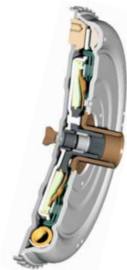
**Bild 24** Dämpfer für Hybridantrieb mit Überbrückungskupplung zur Vermeidung der Resonanz bei Start und Stopp des Verbrennungsmotors
