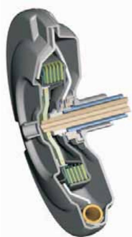
Bild 34 Nasse Anfahrkupplung
