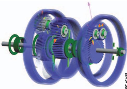
Bild 1: Planetenradsätze eines Automatikgetriebes
