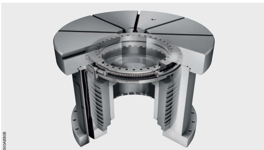
Bild 5: Montagefreundliche Rundtischbaugruppe mit Axial-Radiallager YRTCMA, der Messkopf ist gut zugänglich, die Messspalteinstellung bei Einbau oder Austausch entfällt
