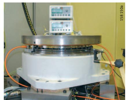
Bild 2: Direkt angetriebener Rundtisch, ausgerüstet mit einem optischen und einem magneto-resistiven Winkel-Mess-System
