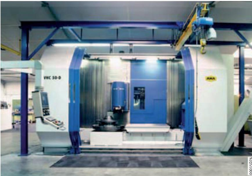
Bild 8: Dreh-/Fräszentrum Typ VHC50-D der AXA Maschinenbau GmbH
