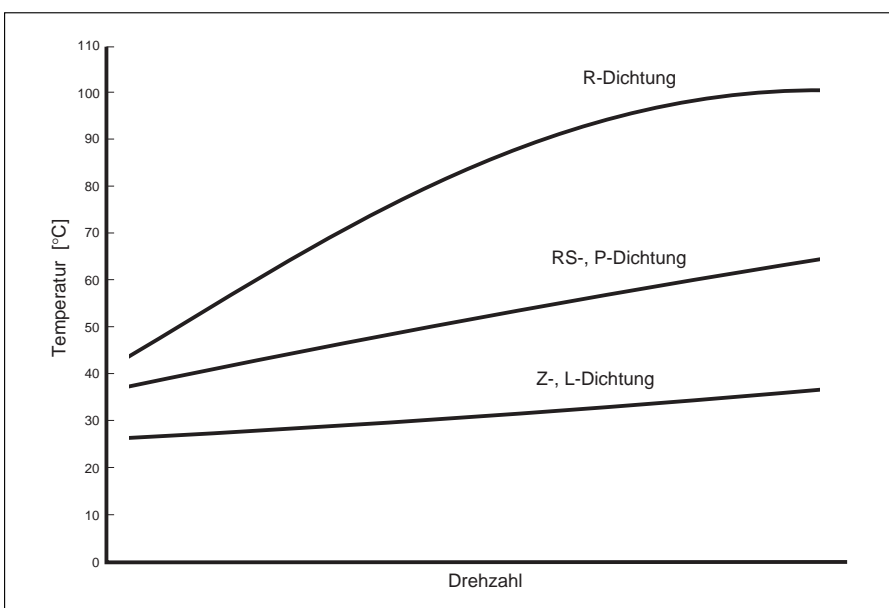
Diagramm 3 Beharrungstemperatur als Funktion der Drehzahl
