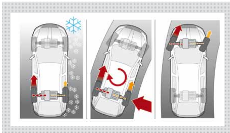
Die elektrische Achse verbessert als eDifferenzial die Traktion (links), die Fahrdynamik (Mitte) und kann die Lenkung unterstützen (rechts).
