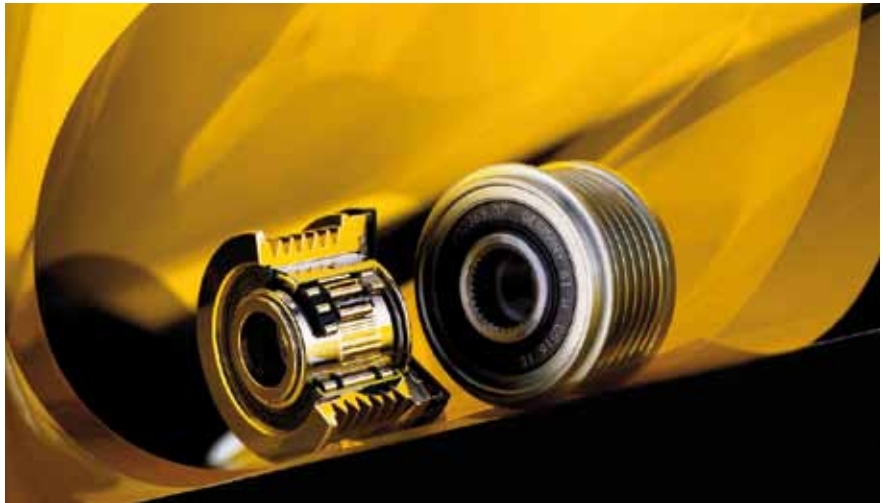
Der Generatorfreilauf unterstützt riemengetriebene Startergeneratoren, die dank 48 Volt Spannung leistungsfähig genug sind, um neben der Start- und Lichtmaschinenfunktion auch für die Rekuperation von Bewegungsenergie und den kurzzeitigen Antrieb der Räder zu sorgen.
