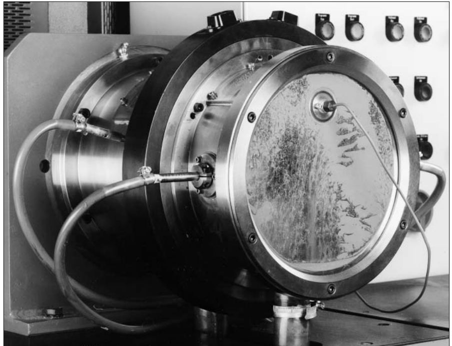
114：检测滚动轴承密封性能的测试台
