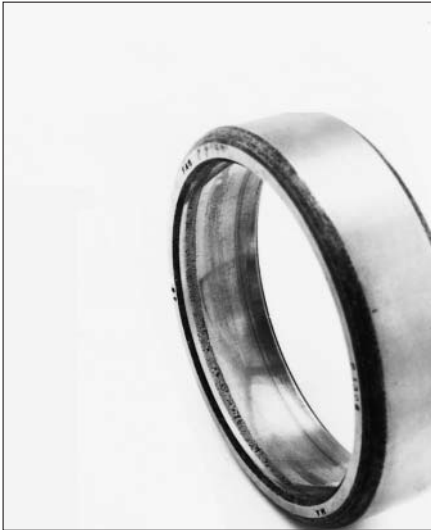
36：轴向过载引起的调心球轴承外圈一列滚道上的剥落。
