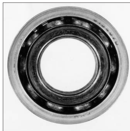
17：在内圈端面的周向划痕和冷焊是内圈在轴上蠕动的结果
