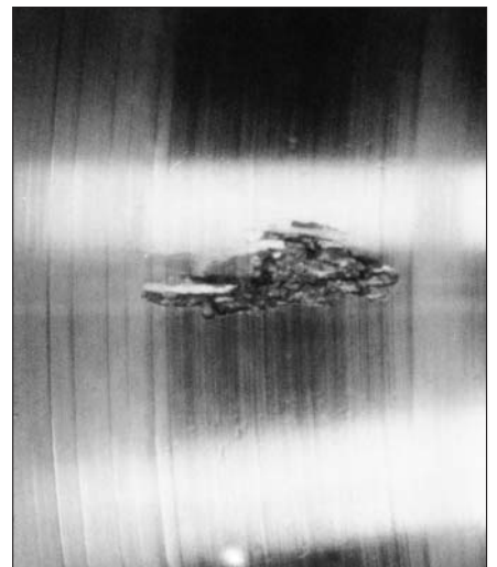
52：疲劳机理如图51，滚道边缘有磨损、滚子横截面轮廓见图69。
