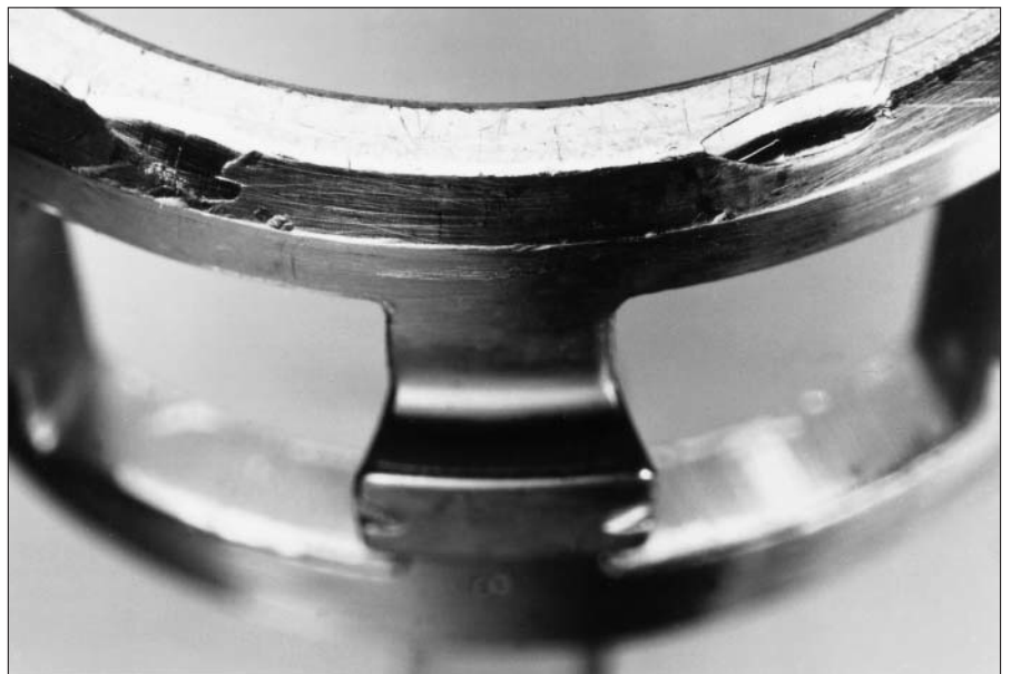
95：带凹坑的金属保持架
