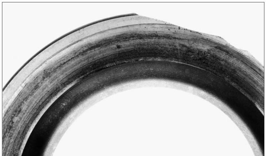
20：由于端面轴向支撑不足，圆锥滚子轴承内圈挡边断裂
