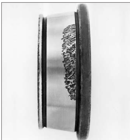
40：圆锥滚子轴承内圈滚道上的倾斜轨迹
