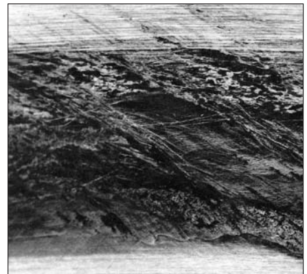
82：当润滑剂供应不充足和载荷太高时，在滚子端面和挡边处会引起胶合
