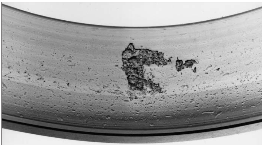
43：圆锥滚子轴承外圈滚道上的疲劳破坏
