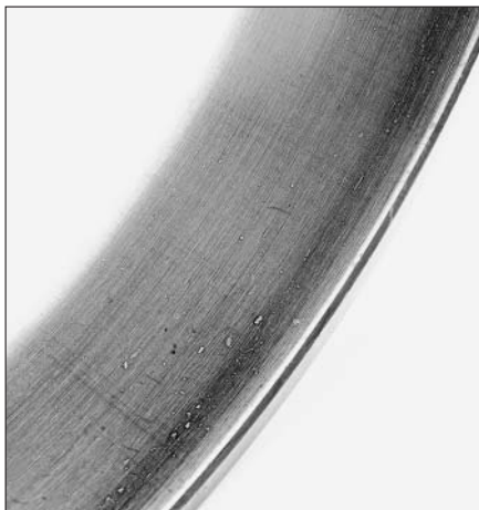
23：正常轨迹，表面结构仍然可见，只有外界微粒造成的小凹痕
