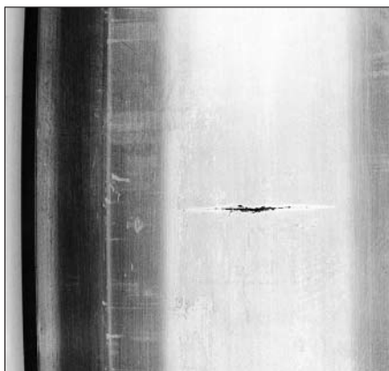
6：通过包络检测法发现造纸机上的调心滚子轴承内圈损坏。
