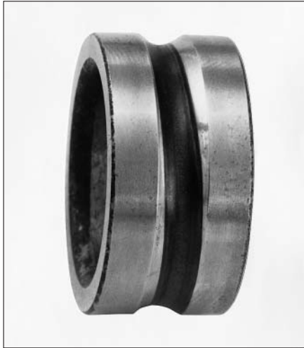
39：深沟球轴承内圈滚道上的倾斜轨迹
