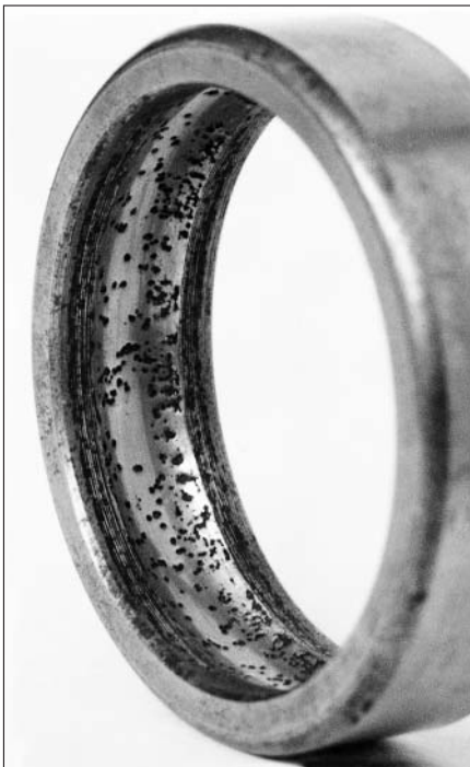
53：锈蚀的深沟球轴承外圈，其防锈保护被湿气破坏
