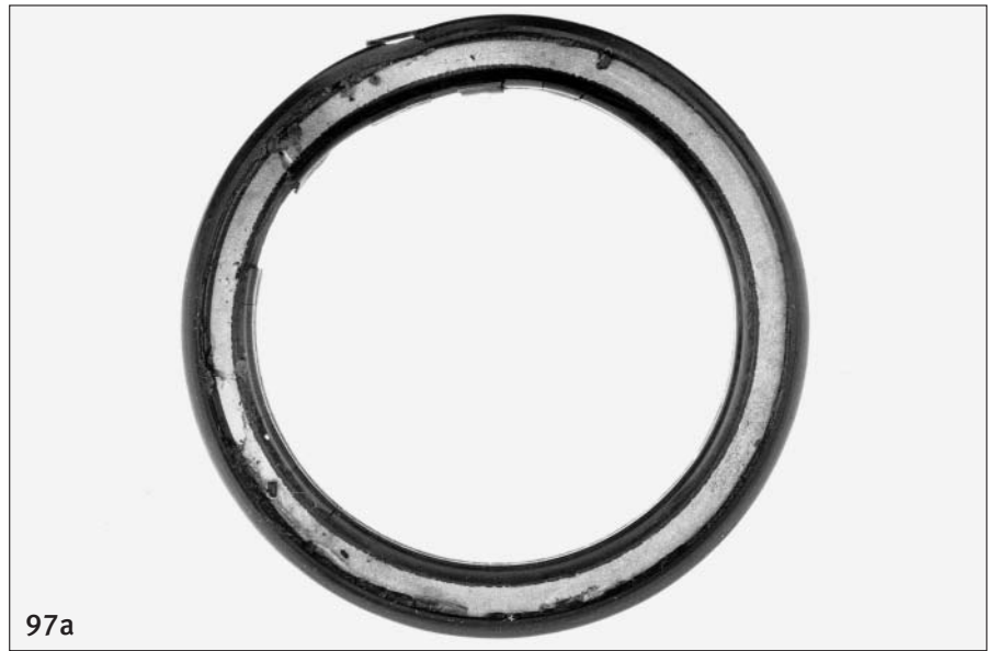
97：a：有磨损和断裂的硬化的密封 b：密封唇口开裂
