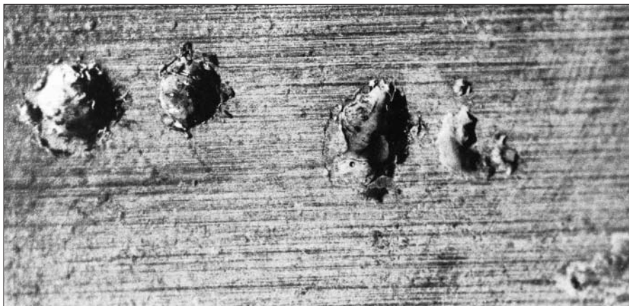
59：电流火花放电形成的圆柱滚子轴承滚道上的凹坑。
