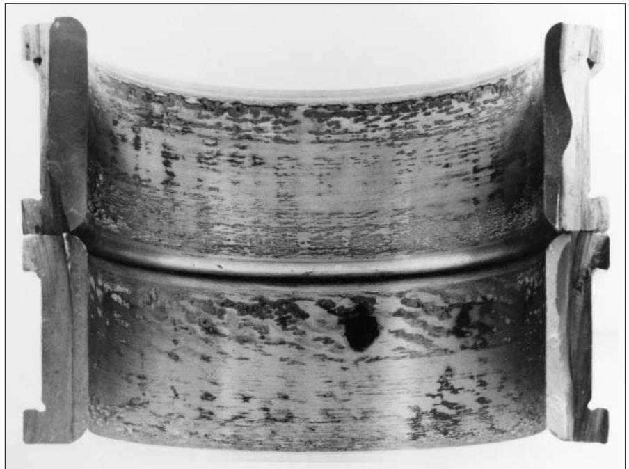
13：配合太松的圆柱滚子轴承内圈内孔的微动腐蚀
