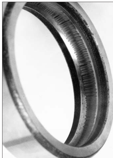
60：深沟球轴承外圈滚道上的凹槽由持续通过的电流造成。
