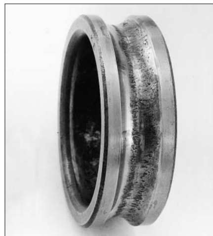
42：深沟球轴承上的进一步的疲劳破坏
