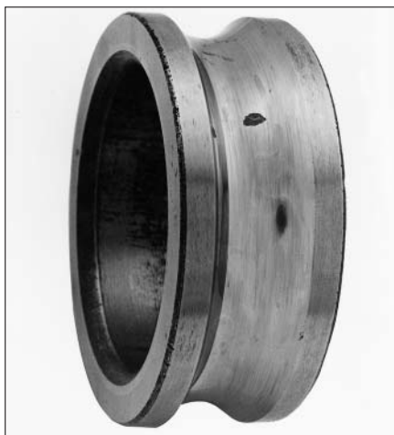
41：通过深沟球轴承内圈滚道上的点蚀可判断的典型疲劳。疲劳进一步扩展，整个滚道上出现材料剥落。
