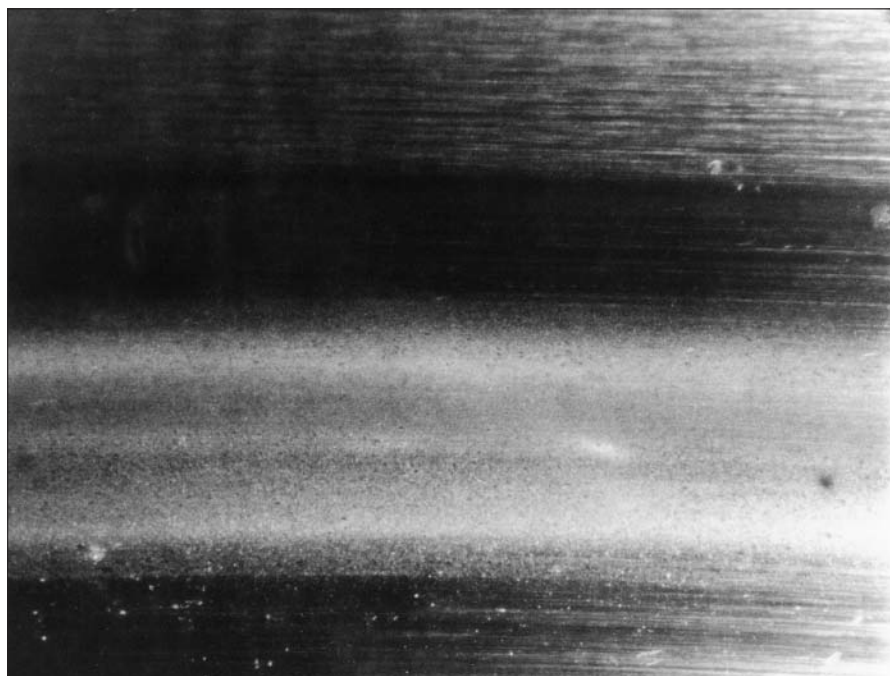
66：磨损、粗糙的滚道
