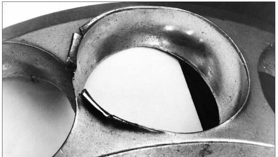
91：轴承套圈的互相倾斜导致在球和保持架中有高的作用力，从而导致保持架兜孔壁断裂。
