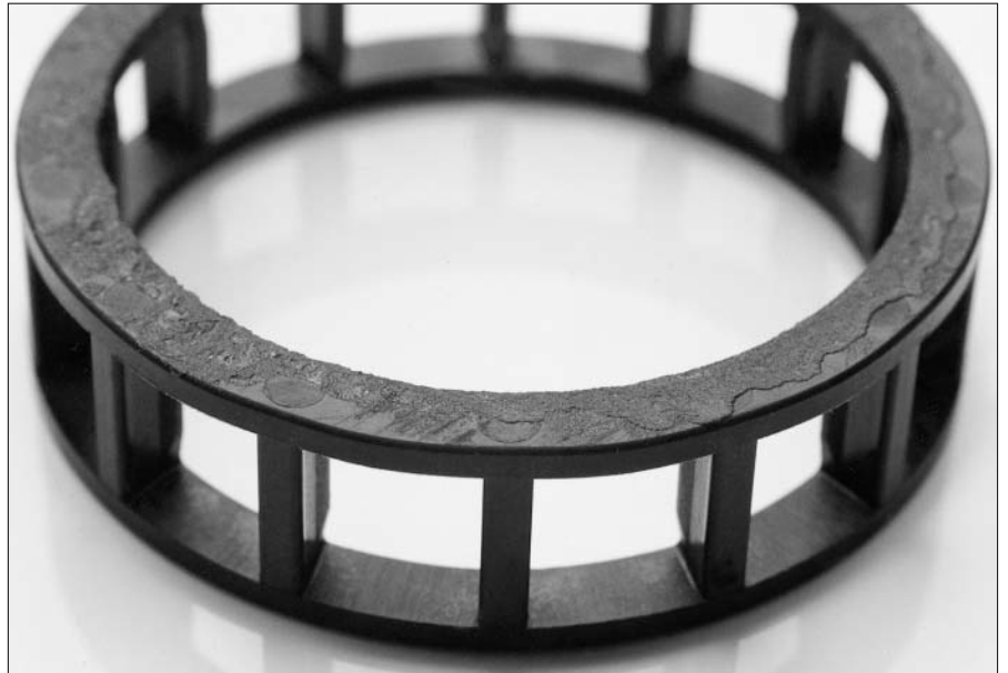
94：熔化的塑料保持架由于在加热板上对轴承进行了不正确的加热
