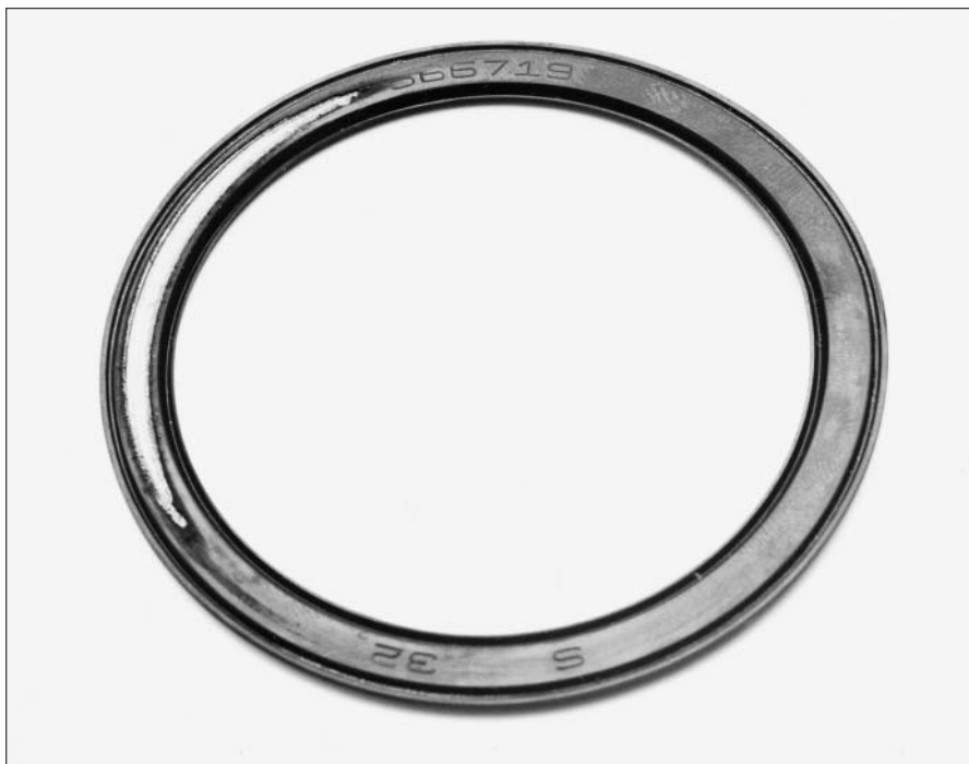
22：由于端面划痕导致密封破坏
