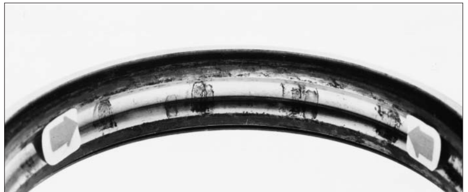
54：在滚道上以滚动体间距分布的腐蚀凹痕
