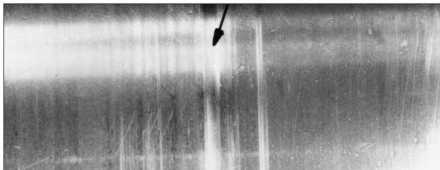
70：保持架上的外界颗粒造成的滚动体上的深度擦伤
