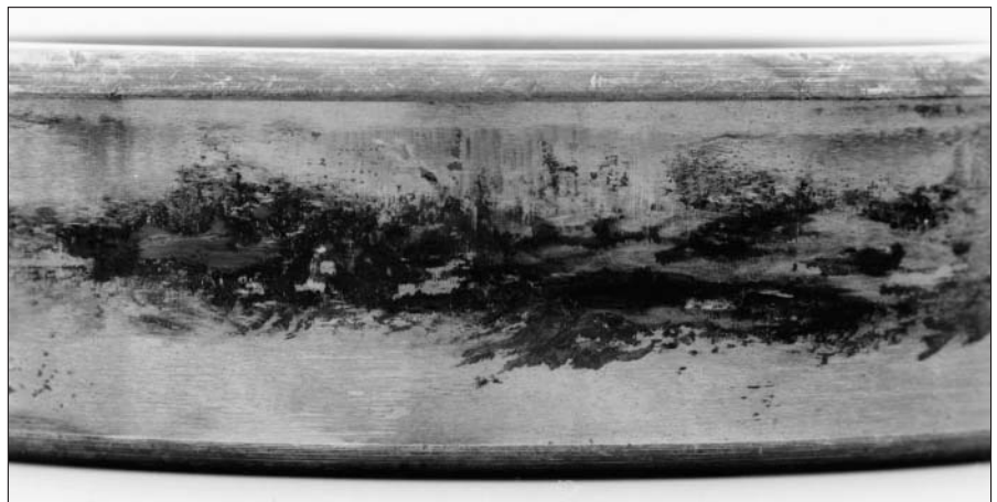
14：静止外圈上的微动腐蚀表明了承载区的范围
