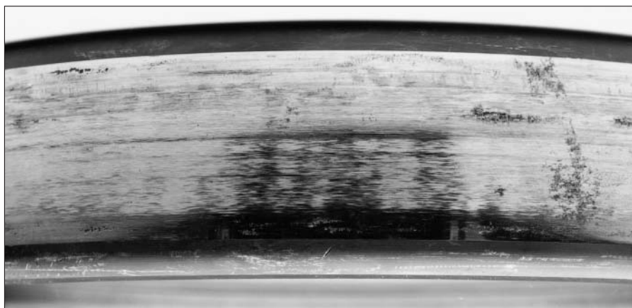
15：外圈外表面上的擦痕是外圈在轴承座里蠕动的结果
