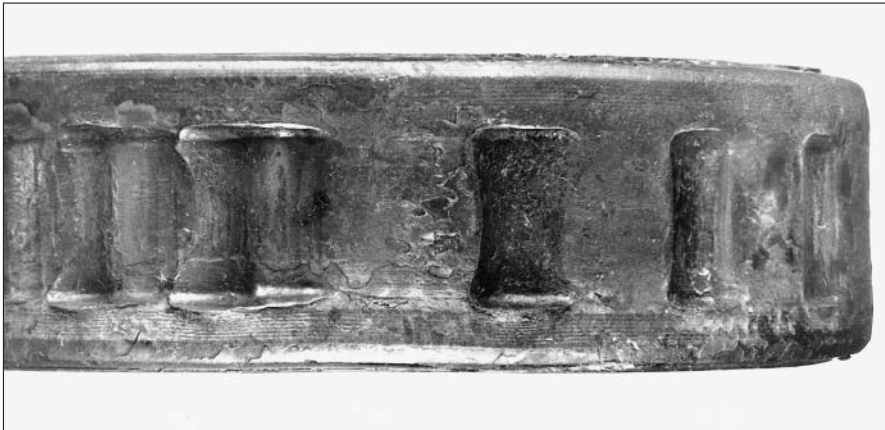
77：过热的圆柱滚子轴承的滚道上滚子留下了很深的胶着的压痕。
