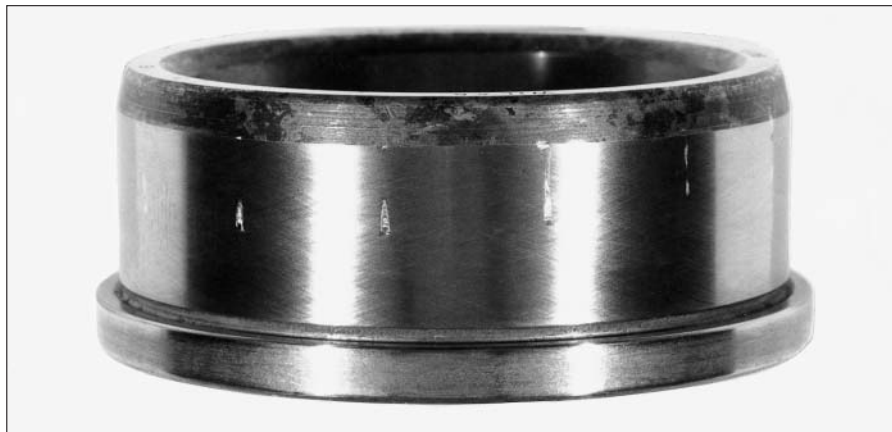
76：圆柱滚子轴承内圈上的划痕是由于内圈装入滚动体组件时有倾斜
