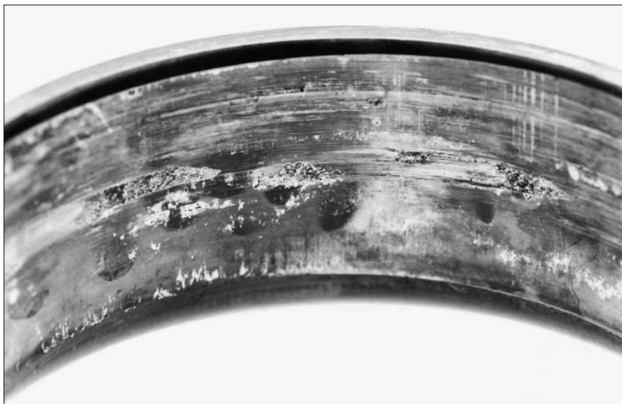
16：内圈内孔上的擦痕是内圈在轴上蠕动的结果
