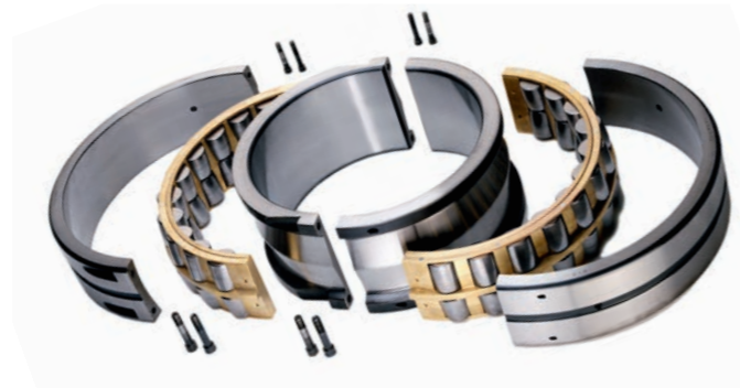
Geteiltes FAG-Pendelrollenlager mit geteiltem Massivkäfig aus glasfaserverstärktem Polyamid oder aus Messing; Spannringe integriert
