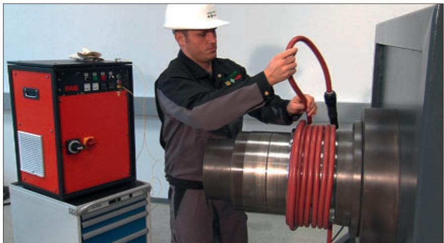
61: Mittelfrequenztechnik mit flexiblem Induktor für den thermischen Ein- und Ausbau von Zylinderrollenlager-Innenringen
