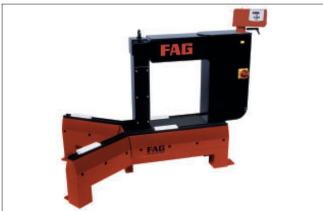
54: Beispiel für ein induktives Anwärmergerät (Heater600)
