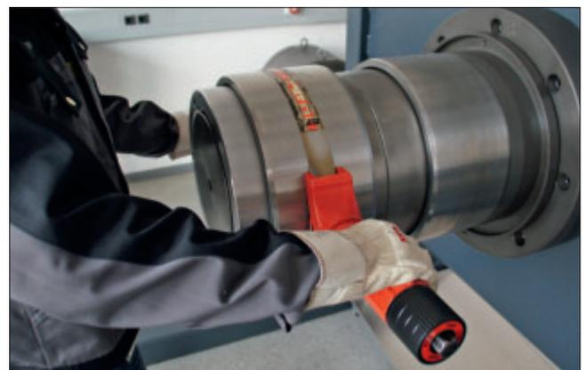
55: Montage des Innenrings eines kleinen Zylinderrollenlagers mittels Bearing-Mate
