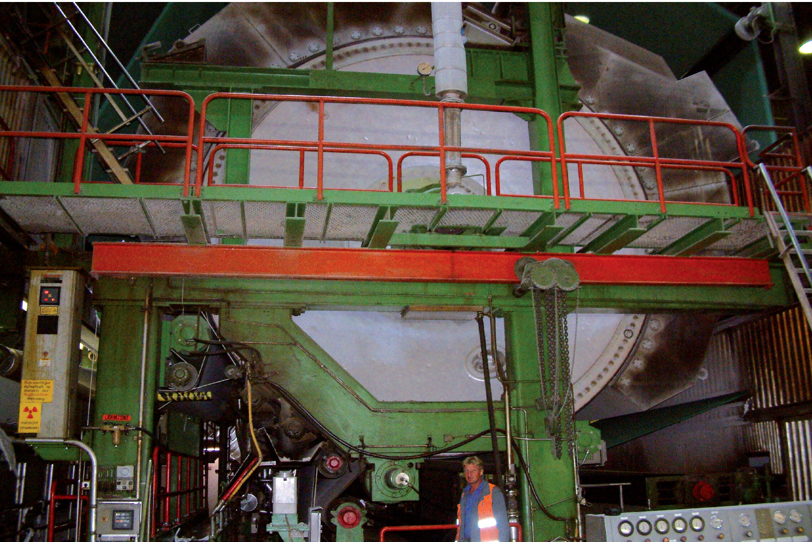
Papierfabrik Lenzing, Österreich Glättzylinder in der Trockenpartie einer Papiermaschine
