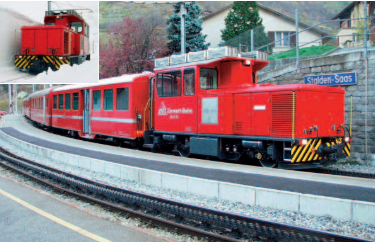
Zahnradbahn HGm 2/2, Nr. 75: Entwickelt und gebaut von der Stadler Bussnang AG, Schweiz Foto: Stadler Bussnang AG
