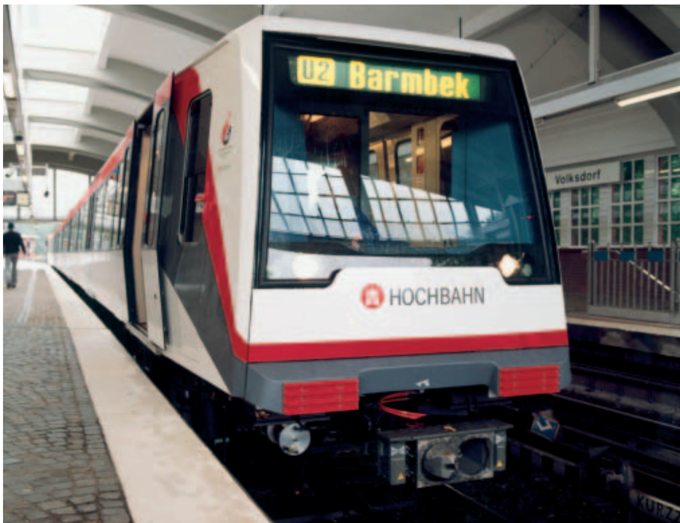
Hamburger Hochbahn Typ DT4: Entwickelt und gebaut von ALSTOM LHB und BOMBARDIER TRANSPORTATION
