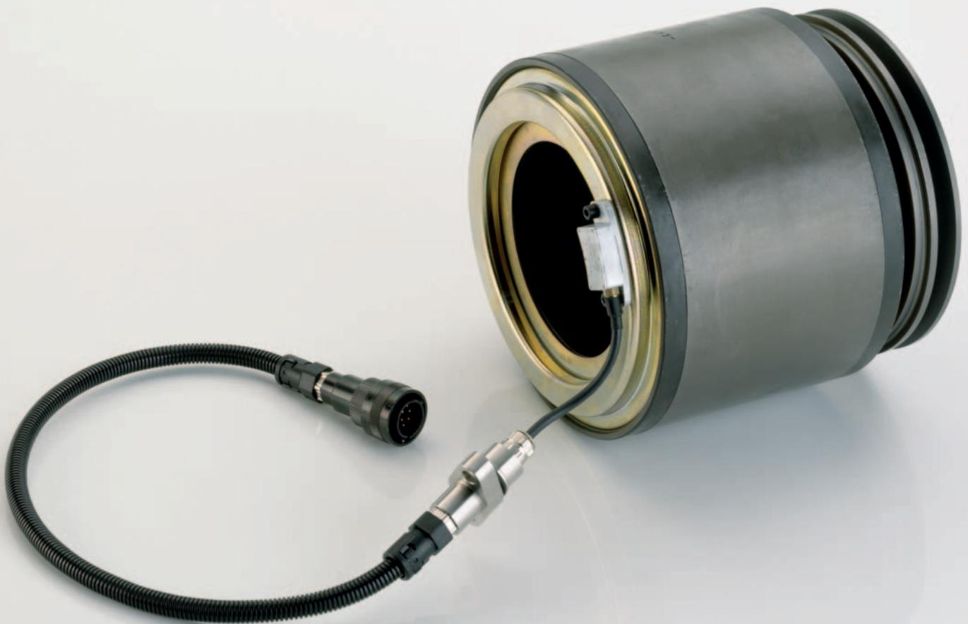
Wälzlager mit integrierter Sensorik für den Radsatz des Hochgeschwindigkeitszuges V250
