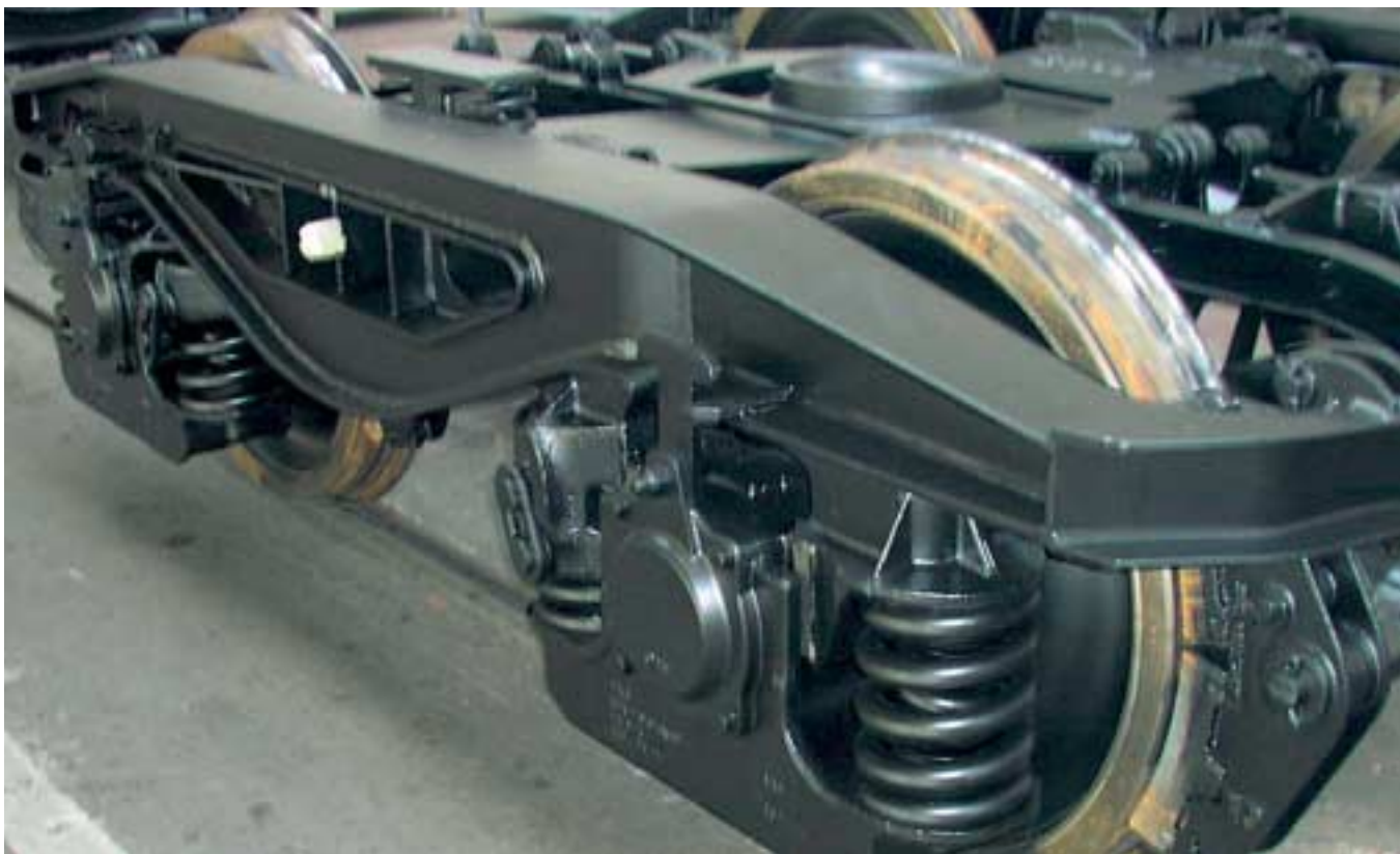
FAG Radsatzlager ASB130Z.176181 für den Einsatz in Y25 Güterwagen-Drehstellen bis 25 t Radsatzlast.
