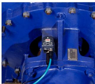
SmartCheck による振動モニタリング
