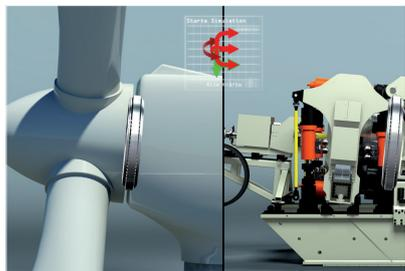
ラジアル油圧シリンダ 4 基とアキシシャル油圧シリンダ 4 基が風車に発生する実際の負荷とモーメントを生成。ラジアルシリンダがロータハブとロータブレードの重量をシミュレーションし、アキシシャルシリンダが風による荷重を生成。
