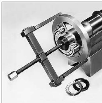
81: Hordógörgős csapágy kiszerése lehúzószerszámmal
