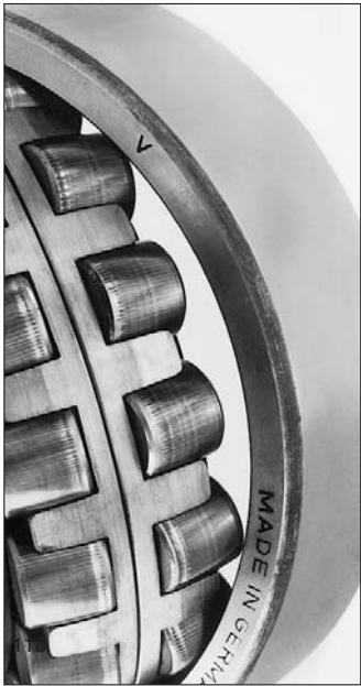
118: Beálló görgőscsapágy barázdált görgői az elektromos áram áthaladás eredményeként
