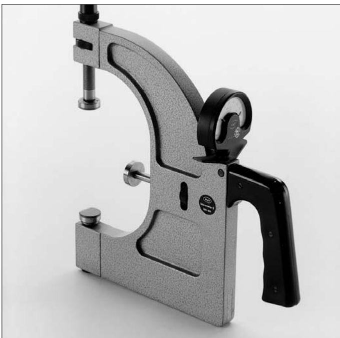
3: Kengyeles mérőműszer biztosítja a pontos pozicionálást a hengeres felület tökéletes méréséhez. A névleges átmérőt a kalibráló mestergyűrűvel állítjuk be.
