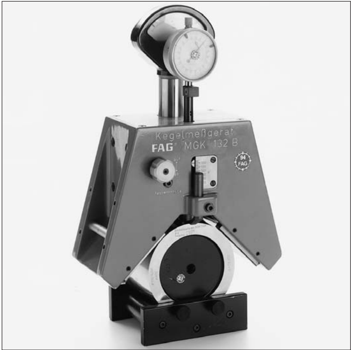
Az FAG MGK 132 kúposságmérő eszköz 80 mm-nél hosszabb és 90 mm-nél nagyobb átmérőjű kúpok mérésére használható (12. ábra).
