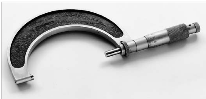
2: Mikrométer a tengelyátmérő méréséhez.
