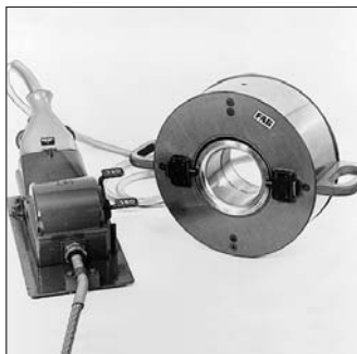
45: 380 V-os indukciós tekercs hengergörgős csapágy belső gyűrűjének fel és leszerelésére
