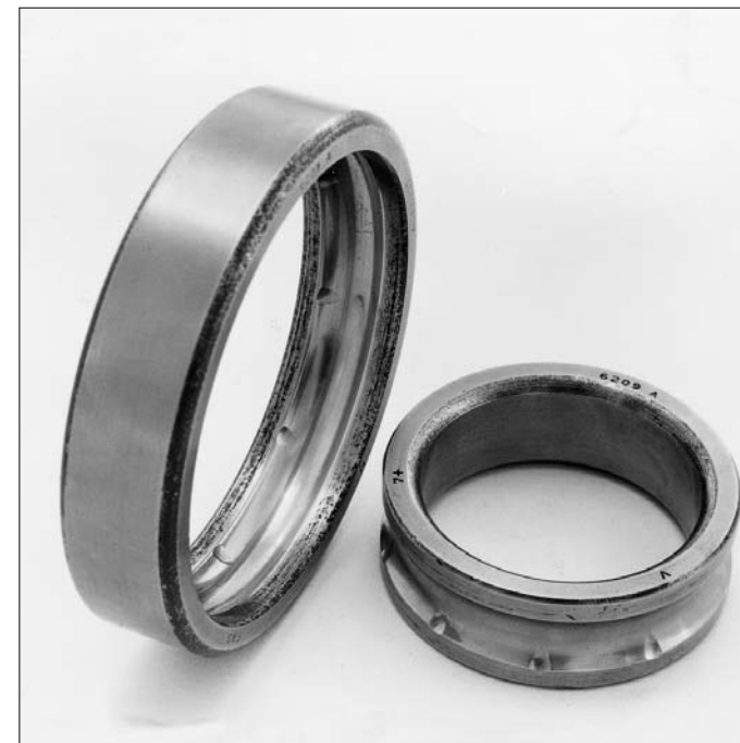
108: Mélyhornyú golyóscsapágy golyóbenyomódása a futófelületen, amely a hibás szerelés következménye
