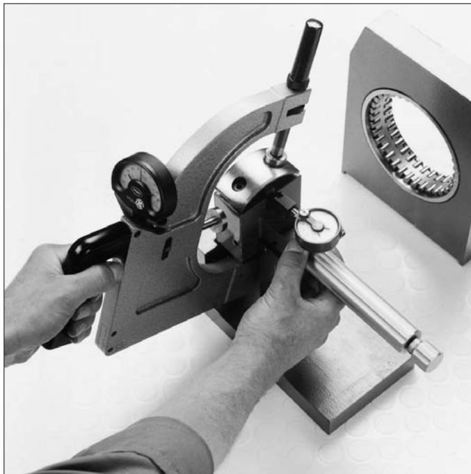
74: A belső burkolókör átmérőt átvisszük a kengyeles mérőműszerre. Az FAG MGI 21 belső burkolókör-mérőműszert kiszerezhető belső gyűrűs hengergörgős csapágyakhoz hasz- nálják, mint pl. az FAG NNU49SK.
