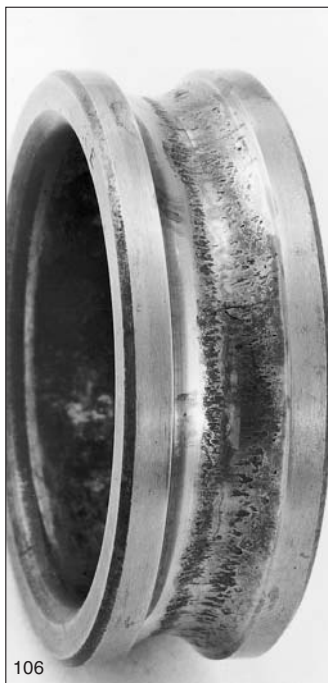
106: Mélyhornyú golyóscsapágy belső gyűrűjének lepattogzása
