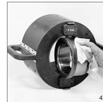
46: Alacsony feszültségű tekercs EFB 125/1-es transzformátorral a 635 mm furatátmérőjű hengergörgős csapágy belső gyűrűjéhez.
