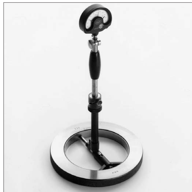
5: Furatok méréséhez különösen alkalmas a mérőórás műszer. A képen látható mestergyűrűt alkalmazzuk a névleges méret beállításához.
