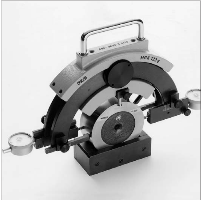
Az FAG MGK 133 kúpmérő műszer a 80 mm-nél rövidebb kúpok mérésére szolgál (11. ábra).
